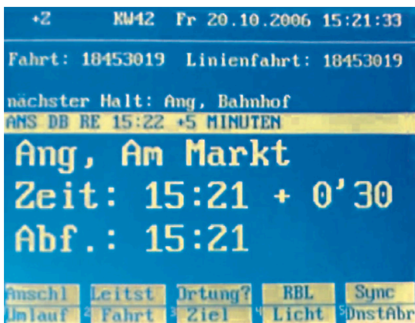
Рисунок 47 Детали о задержке регионального экспресса (ANS(chluss)DB RE), отображаемые на бортовых компьютерах, находящихся в средствах общественного транспорта.
