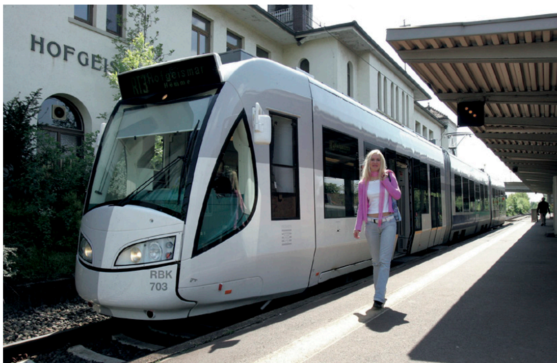
Рисунок 13 Региональный трамвай RegioTram как двухсистемное или гибридное транспортное средство, которое передвигается как в городской легкорельсовой системе, так и на региональных железнодорожных маршрутах (Транспортное объединение Северного Гессена (Nordhessischer Verkehrsverbund, NVV)).
